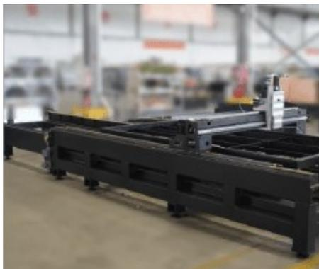
Передняя станина сварена из листов высококачественной углеродистой стали, выдерживающих лазеры мощностью 1 кВт-20 кВт.
