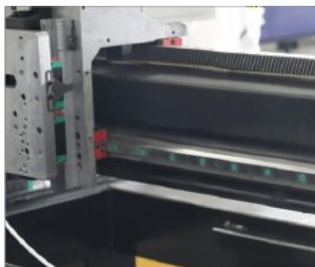
**На оси X используются направляющие и ползуны тайваньского бренда HIWIN, который в сочетании с косозубой стойкой YUC обеспечивают высокую точность станка. Ось Z использует шарико-винтовую передачу, что обеспечивает более высокую точность.**
