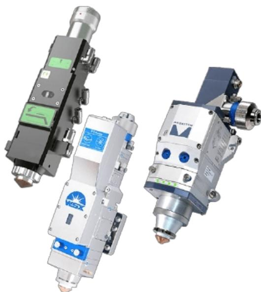
Лазерный луч фокусируется линзой в режущей головке и затем воздействует на поверхность обрабатываемого материала, испаряя его и завершая резку с помощью вспомогательного газа.
