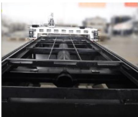
Станина сваривается из высокопрочных стальных листов, которые имеют более высокую прочность, чем сварная квадратная труба. Станина имеет полуполую конструкцию и малую площадь нагрева, что позволяет избежать деформации станины из-за длительного воздействия высокой температуры. Это гарантирует долгосрочный выпуск изделий и стабильную резку.
